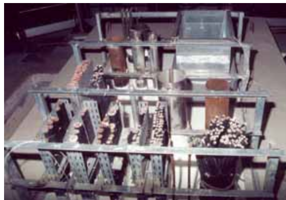
Photo B - Système Laine de roche + Enduit : Maquette en dalle avec traversants multiples
